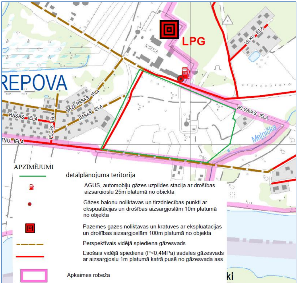
3.23.attēls. Detālplānojuma teritorijā esošie gāzes apgādes tīkli
