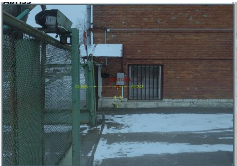
11.att. Vietējā ģeodēziskā tīkla punkts-sienas marka 1051. Punkts atrodas Slāvu ielas Nr. 2A ēkas sienā.
