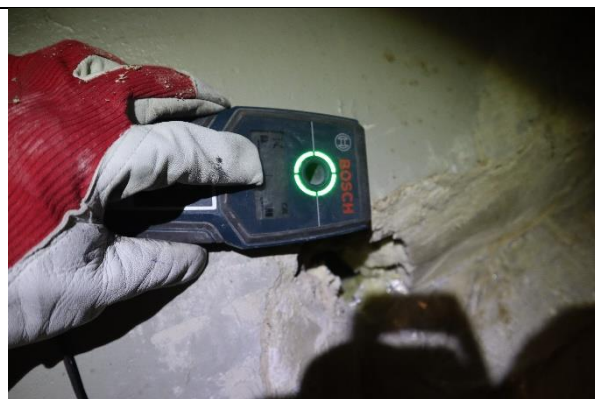
4.29.att. Pārbaude ar metāla detektoru
