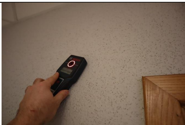
4.3.att. Tērauda elementa balsta attāluma noteikšana
